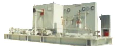
Завеса типа «одеяла», установленная на модели компрессора LMC-333, покрывает технологическую оконечность компрессора и мультипликатор. Среднее уменьшение шума составляет 5–10 дБА.
