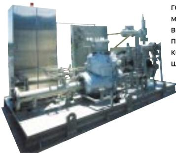
Завеса панельного типа, установленная на горизонтальной установке, со съёмными панелями, манометрическим пультом и принудительной воздушной вентиляцией. Размер данного устройства позволяет покрыть технологическую оконечность компрессора и мультипликатор. Среднее уменьшение шума составляет 10 дБА.
