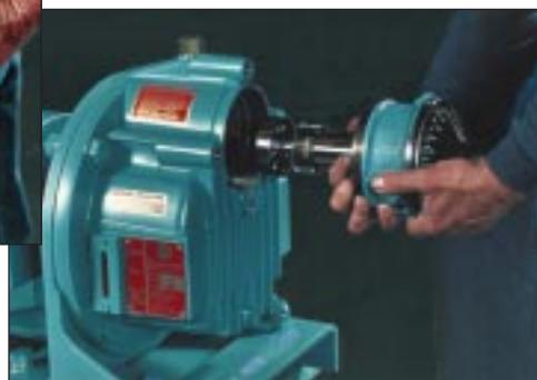
3. Простота разборки узла высокоскоростного вала в сборе.
