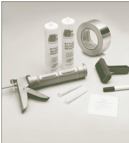
**Монтажный набор RTM:** Включает материалы и инструменты, необходимые для монтажа панелей RTF FlexiPanel. Набор включает клей с приспособлением для его нанесения, распорку, валик и соединительную ленту. Один набор позволяет установить до 7500 см<sup>2</sup> панелей.
